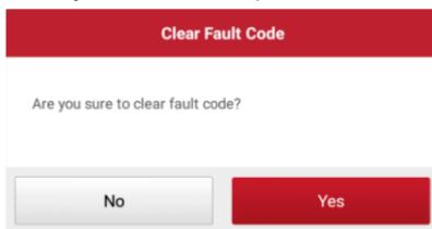
Замечание: если коды неисправности присутствуют в системе, пожалуйста, выполните поиск неисправностей с применением заводских алгоритмов, затем устраните неисправность, удалите коды и повторно проверьте их отсутствие.
