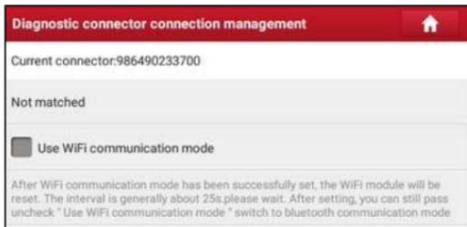
Чтобы планшетный компьютер работал с соединителем VCI через Wi-Fi, выполните следующие действия:
