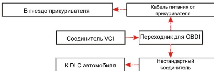
B. кабеля питания с зажимами для АКБ: подключите один конец кабеля питания с зажимами АКБ к выводам АКБ, а другой конец кабеля к силовому разъему кабеля-переходника для **OBDI**
