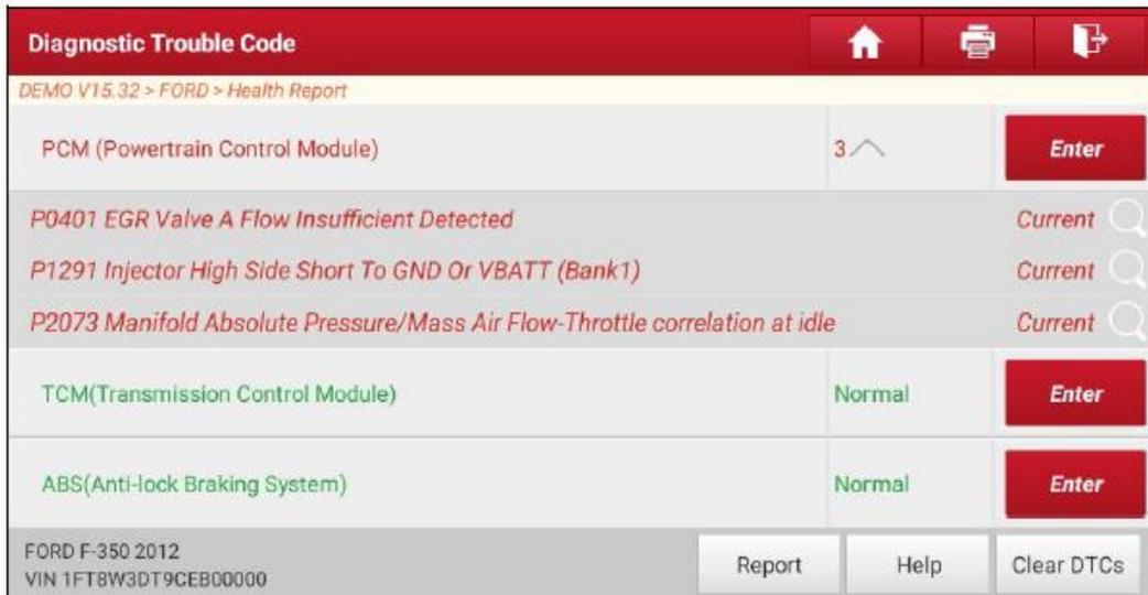
Протестированная система с кодом неисправности отображается красным цветом, а правильно работающие системы отображаются черным цветом.
